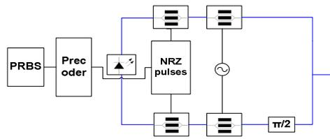
Figure 2 DQPSK RZ transmitter
